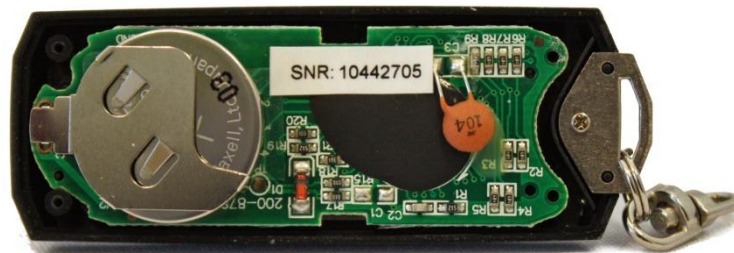
Abbildung 8: Batteriewechsel beim OTP-Token (2)
