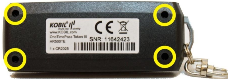
Abbildung 7: Batteriewechsel beim OTP-Token (1)
